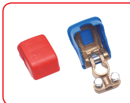
Sistema di chiusura a pressione Locking pressure system Ottone stagnato / Tin plated brass 1000 A - Cavo / Cable 16/50 mm 2 Cod. 40040
